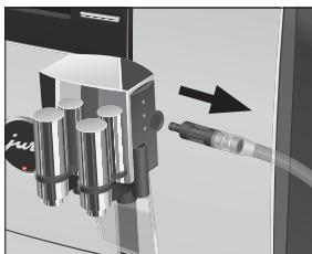
▶ Снимите молочный шланг и тщательно его промойте под проточной водой.
